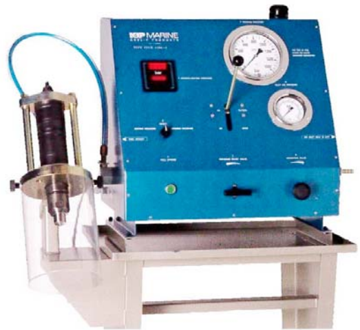
図2 スライド弁用燃料弁テスト装置VPUD 1100
